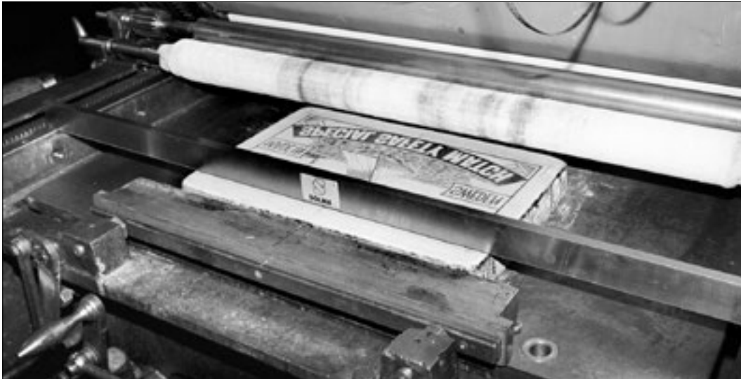
Bild 25: Vagnens referensytor är utgångsläge för höjdställning av stenen.
