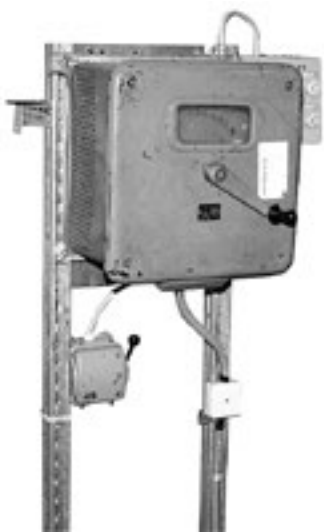
Bild 13: Kraftaggregatet startas med en knivbrytare och ett pådrag.
