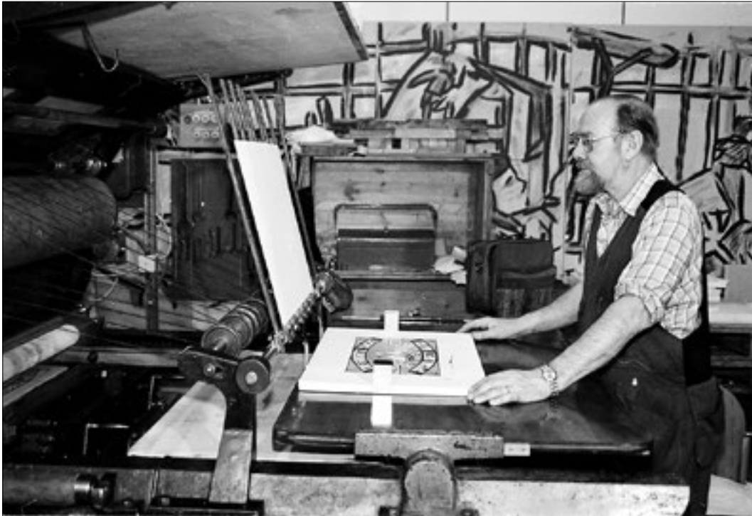
Bild 10: Den självverkande avläggaren. Pinnavläggaren vänder pappersarket så att bildsidan kommer upp.
