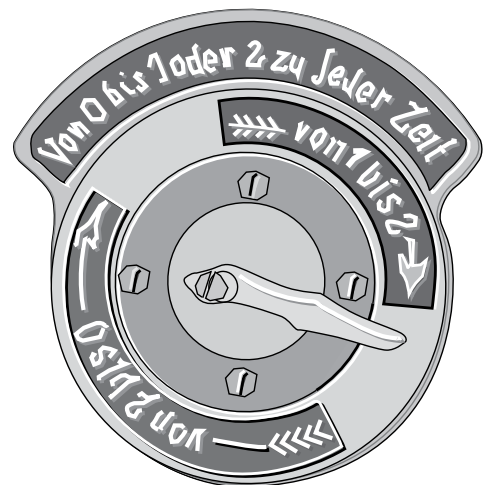
Bild 15: Plattan visar i vilka lägen omkoppling sker.
