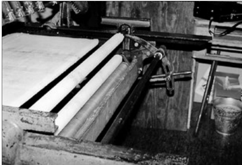
Bild 2: Fuktlådan med duktor, överföringsvals och hoppvals.
