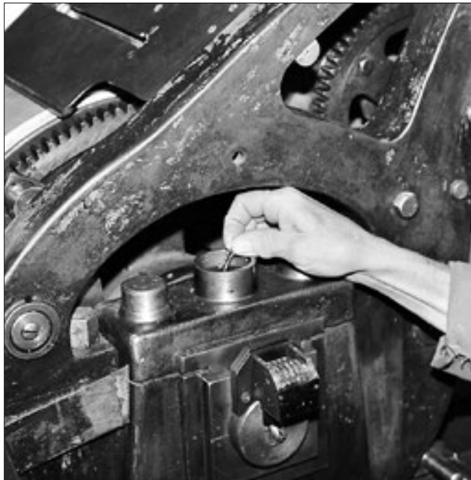
Bild 17: Smörjkopporna ovanför cylinderaxeln kontrolleras och smörjveckarna läggs i oljeröret. Olja fylls på vid behov.
