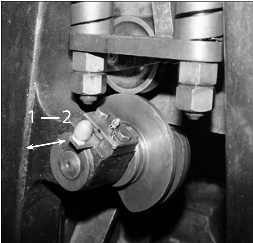
Bild 16: Inställningen för enkelt och dubbelt tryck. Spaken utdragen – enkelt tryck, spaken inskjuten – dubbelt tryck.
