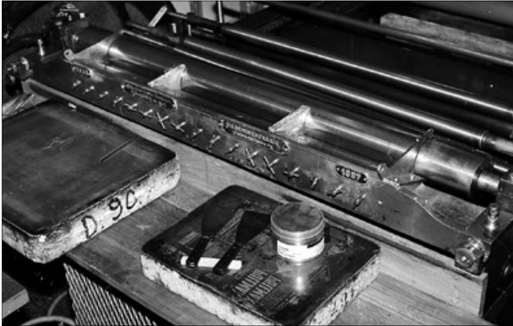
Bild 4: Färgmängden regleras med 17 färgskruvar. Kniven kan frikopplas från duktorn med hjälp av justerskruvar.
