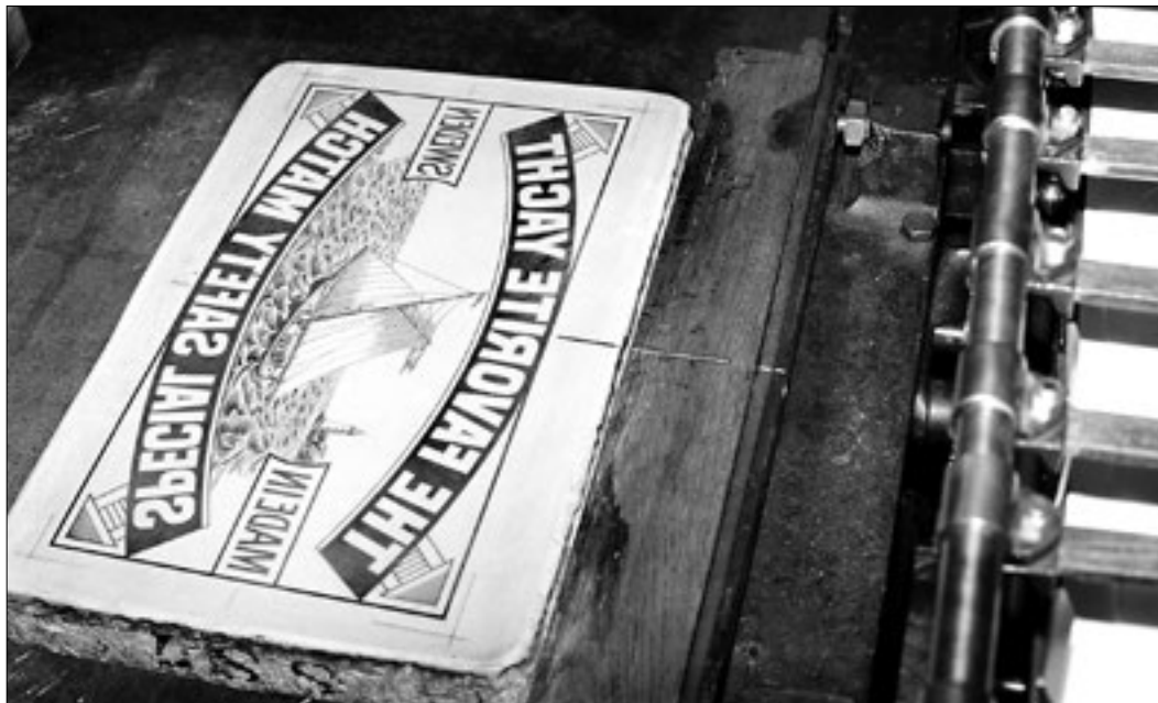
Bild 29: Stenen placeras så att bildens mittmärke kommer i linje med fundamentets mittmärke.
