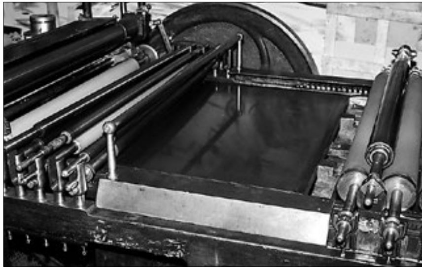
Bild 8: Färgbordet som transporterar färg från överföringsvals till formvalsarna.
