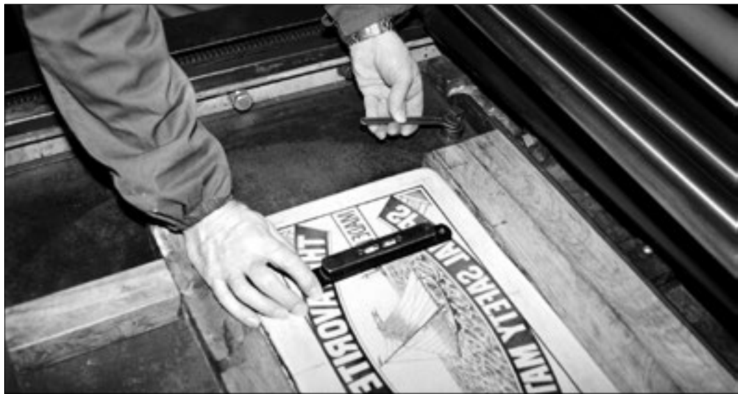
Bild 27: För justering av stenens vågläge används två skruvar i bakkant av fundamentet. Kontroll sker med vattenpass.
