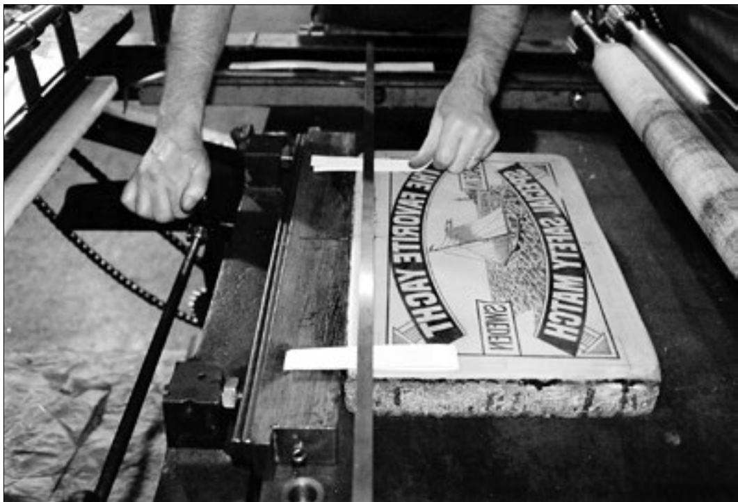
Bild 28: Den exakt slipade inställningslinjalen läggs över stenens framkant och på vagnens referensytor varefter stenen höjs upp till linjalens underkant. Kontroll sker med pappersremсор.
