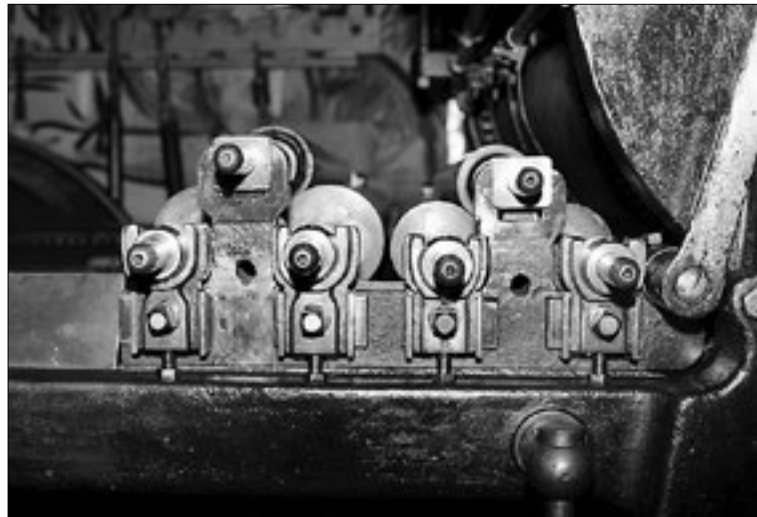
Bild 21: Färgformvalsarna löper i glidlager som ligger i lagerbockar. Lagrets höjdläge justeras med en skruv.
