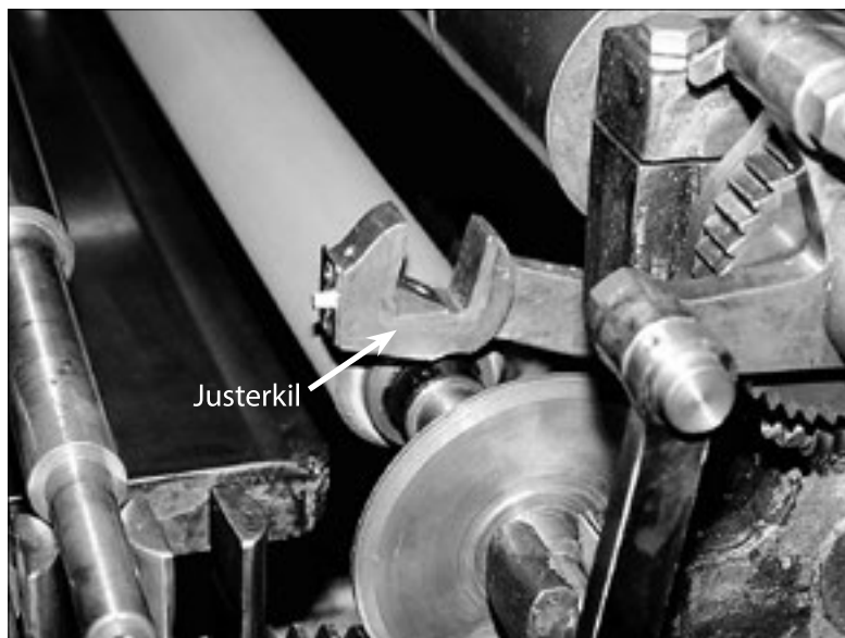
Bild 7: Överföringsvalsens drivning och justerkil för hoppvalsen.
