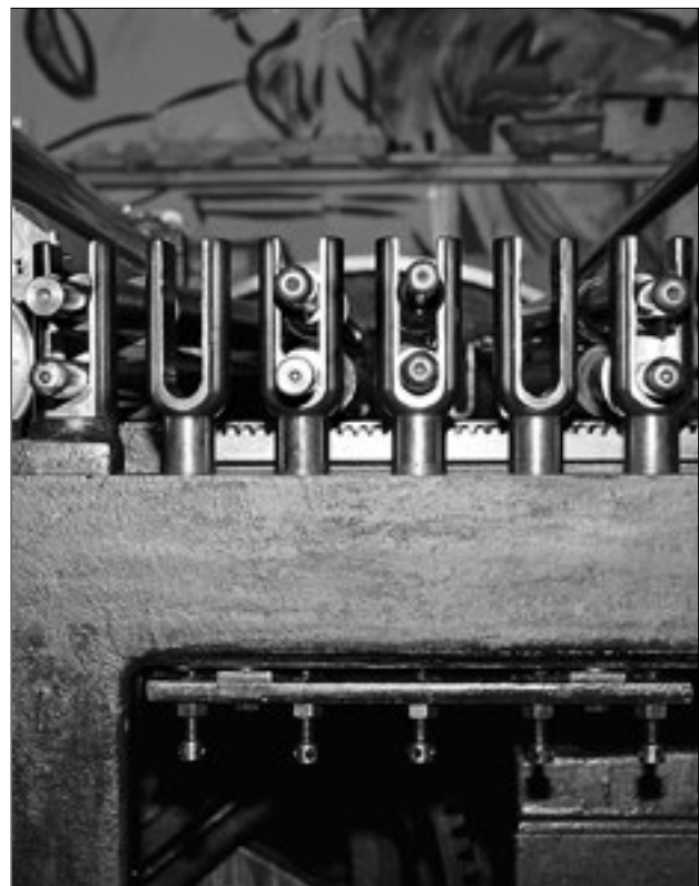
Bild 19: Utjämningsvalsarna justeras med hjälp av justerskruvar som höjer och sänker gafflarna.
